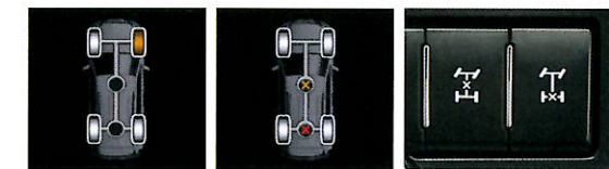
4輪トラクション作動表示例 | デフロック作動表示例 | センターデフロックスイッチ&リヤデフロックスイッチ(マルチトレインセレクト装着車)
