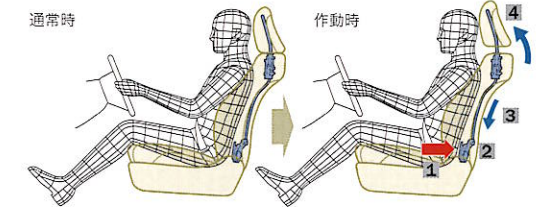
通常時 作動時 1 腰がシートバックを押す 2 ロアユニットを押す 3 ケーブルを引っ張る 4 アッパーユニットにより斜め上方に移動する アクティブヘッドレスト
