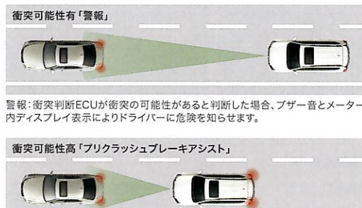
衝突可能性「警告」 警告:衝突判断ECUが衝突の可能性があるとして判断した場合、ブザー音とメーター内ディスプレイ表示によりドライバーに危険を知らせます。
