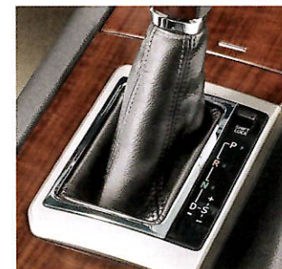
スーパーインテリジェント5速オートマチック(5 Super ECT)+シーケンシャルシフトマチック
