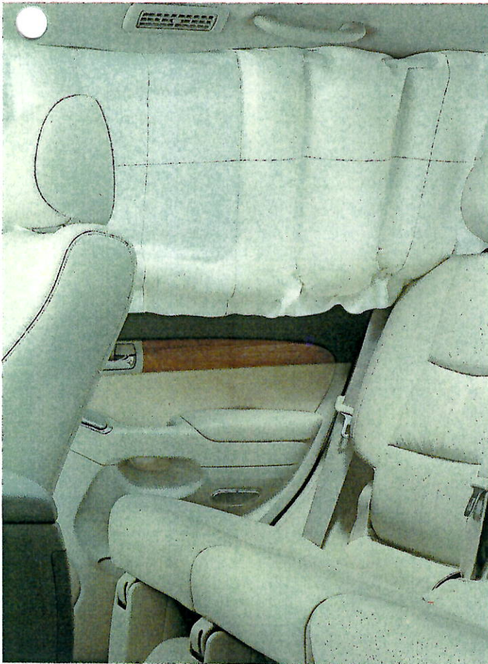
SRSサイドエアバッグ(フロントシート)&SRSカーテンシールドエアバッグ(フロントシート・セカンドシート) ■写真は機能説明のためSRSエアバッグが作動した状態を再現したものです。
