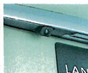
カラーバックガイドモニター カメラ部 (バックドアガーニッシュ下側)
