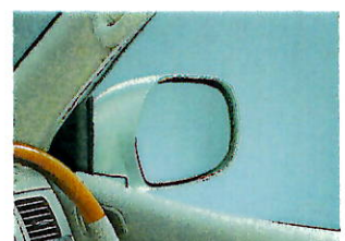
電動格納式リモコンカラーオートミラー (レインクリアリング機能付)
