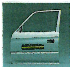
●サイドドアビーム (写真は説明のために着色したものです。)
