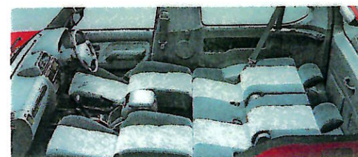
■フロントシートフルフラット & リヤシートフルリクライニング状態
