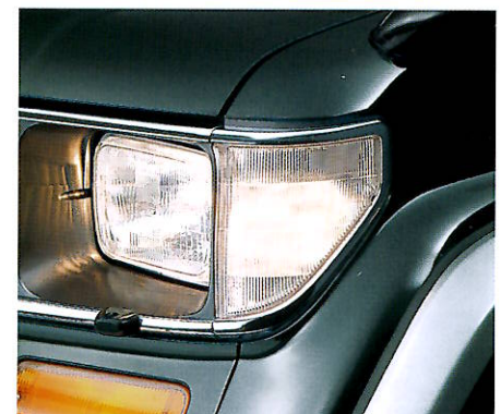
コーナリングランプ(全車に標準) ヘッドランプ点灯時のみ作動します。
