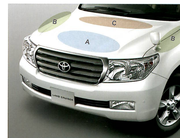
歩行者傷害軽減ボディ構造 A: フード部 B: フェンダー部 C: カウル部
