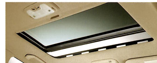
マイコン制御チルト&スライド電動式ムーンルーフ (挟み込み防止機能+ドアキー連動機能付)
