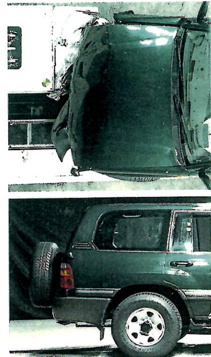
オフセット前面衝突実験 (60km/h) ■写真は実験用の試作車です。
