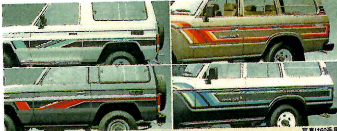
サイドストライプ 幌タイプを除く70系全車、60系ハイルーフ車にオプション 写真は70系用
