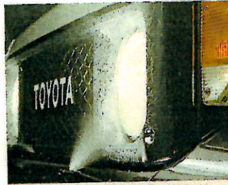
ハロゲンヘッドランプ&ヘッドランプクリーナー ハロゲンヘッドランプは全車にオプション ヘッドランプクリーナーは70系LX、60系全車にオプション
