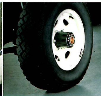
215SR15ラジアルタイヤ&ホワイトスポーツホイール (GXのみ標準、フリーホイールハブはオプション)
