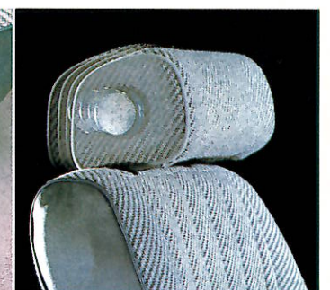
前後上下調整式ヘッドレスト (HJのみ)
