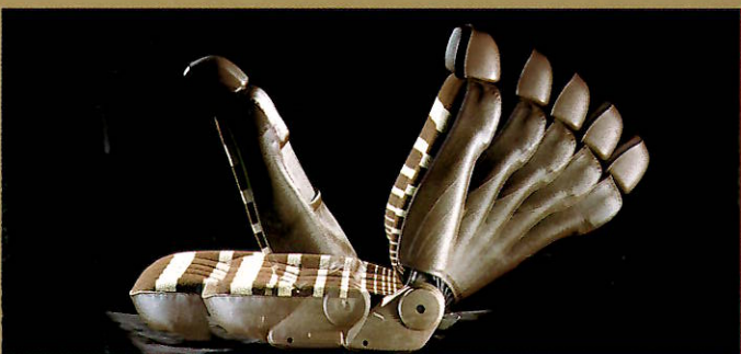
15段階式運転席リクライニングシート (BJ42、BJ46を除く全車に標準)
