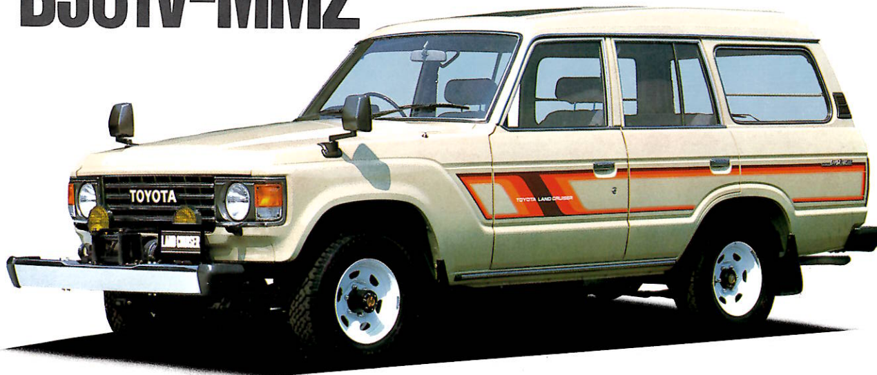
写真はHJ60V-MMZ(W) (GX): 2人乗り+350kg積、または5人乗り+200kg積 ●サイドストライプ、フリーホイールハブ、ハロゲンヘッドランプ、メッシュタイプフォグランプ、ヘッドランプクリーナーはオプション。
