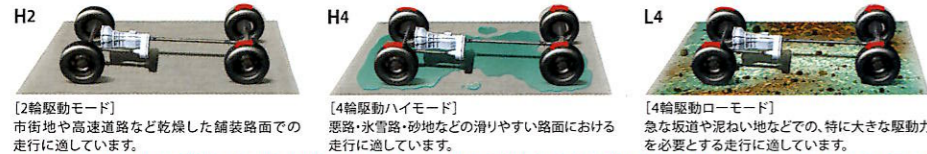
[アクティブトラクションコントロール作動イメージ(4WD走行時)]
